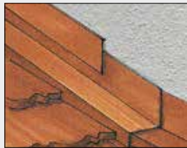
Overgangsbeslag mot mur
